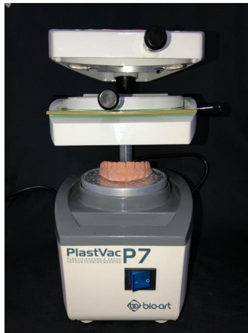
Figura 6 – Plastificadora com a placa ajustada e com o modelo na base da plastificadora preparando para o aquecimento
