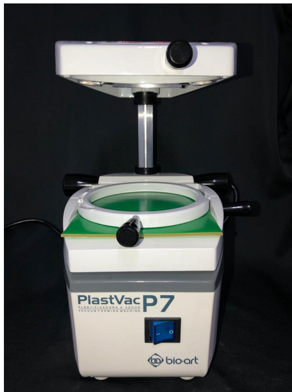
Figura 5 – Imagem da plastificadora com a placa ajustada para posteriormente fazer o aquecimento do material
