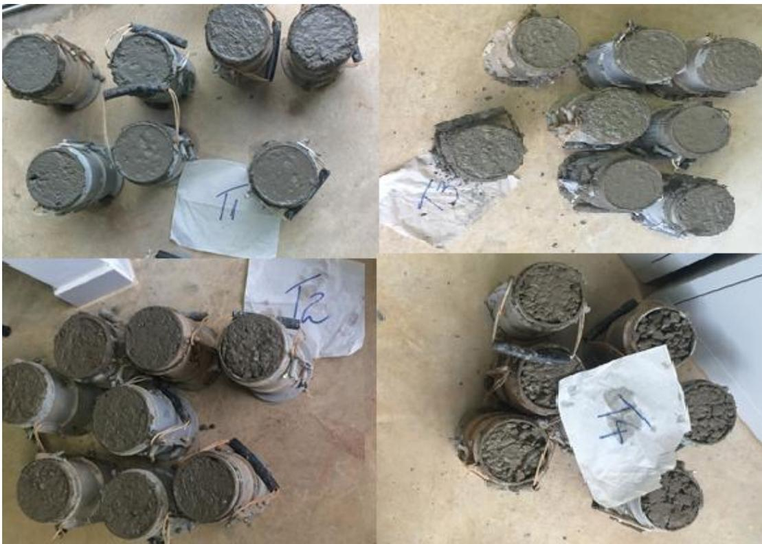
Depois de realizados os testes de compressão, pode-se verificar cada resultado dos corpos de prova com adição do resíduo, que conclui-se que:
