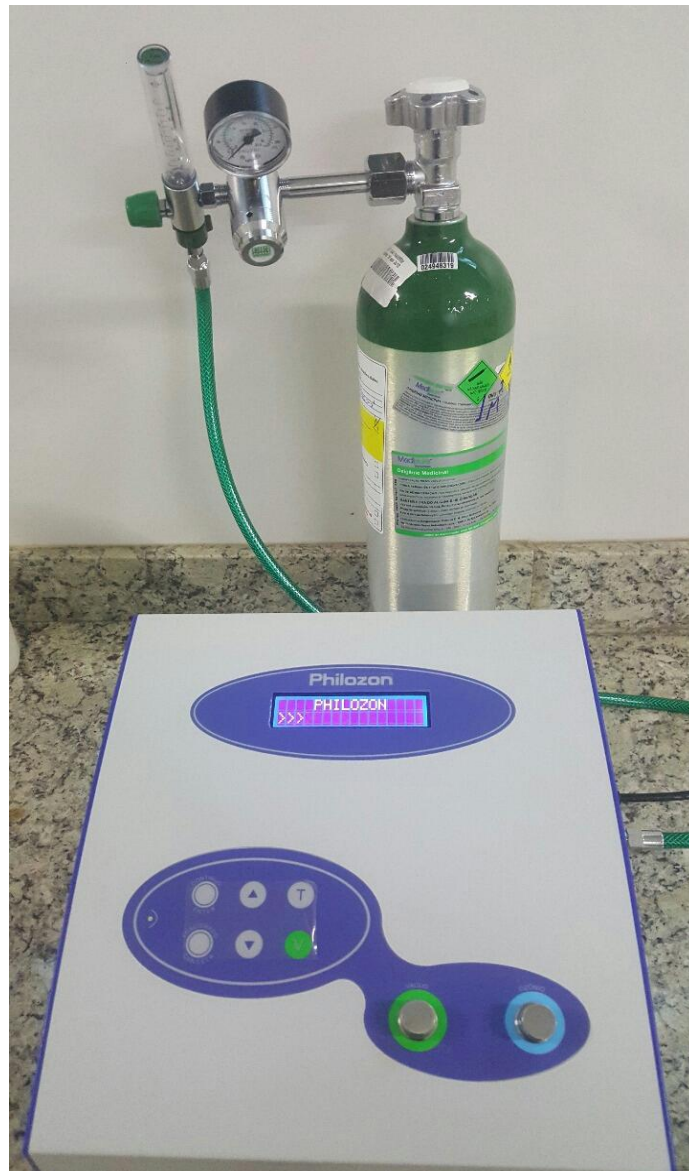
Fig 2: Máquina geradora de ozônio (Philozon). Arquivo particular: Prof. a Me; Lia Dietrich
