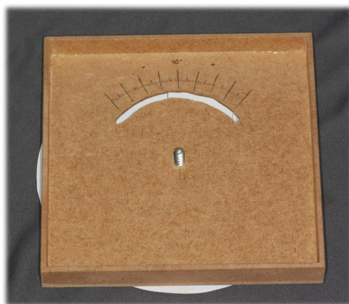
Figura 03: Porção interna do verso da caixa observando a graduação para leitura do ângulo de inclinação da foto.
