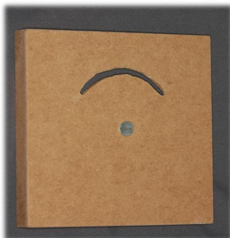
Figura 02: Porção externa do dispositivo criado utilizando caixa e parafuso, e o corte da caixa para análise da inclinação da foto.
