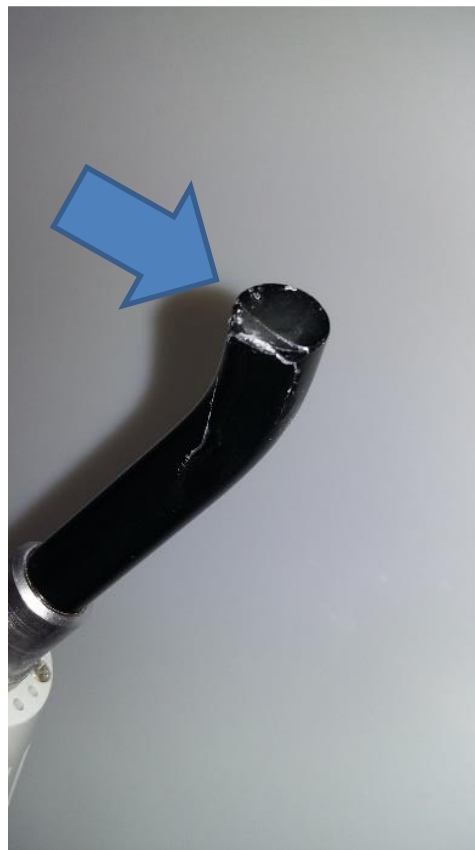
Fig.9 :ponteira com fratura
