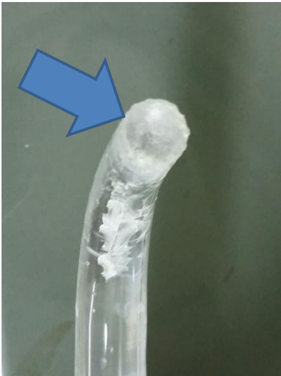
Fig.7 : ponteira com dentritos
