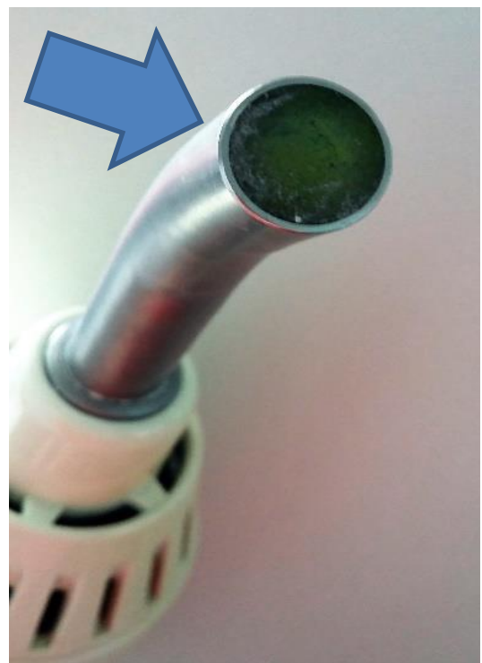
Fig.8: ponteira com dentritos
