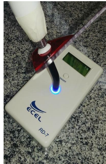
Fig.2. Ponta do fotopolimerizador centralizada e paralela à célula
